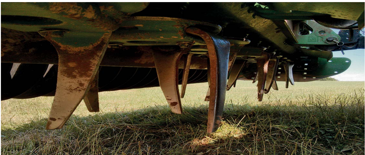
Bild 34: Die auf Griff eingestellten Zinken des Amazone Kreiselschärfers zeigten eine sehr gute quetschende Wirkung auf den Engerling; 23.7.2013.
