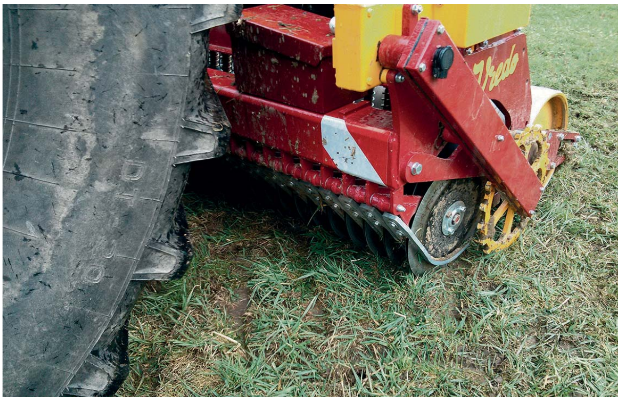
Bild 58: Jeweils zwei konisch zueinander gestellte Schneidscheiben öffnen einen Säschlitz, in den die Pilzgerste abgelegt wird. Mit der wassergefüllten Walze wird der Schlitz möglichst wieder geschlossen; 16.4.2013.
