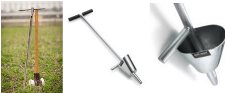
Abbildung 2: Schlagbohrer; Schüsserlbohrer zur Beprobung von Grünlandflächen
