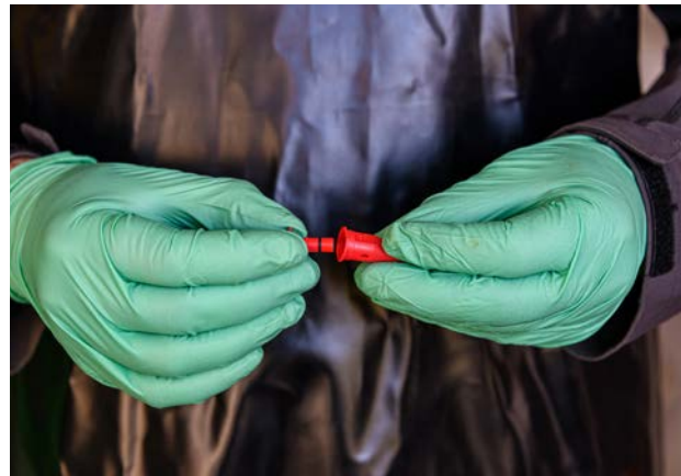
Abb. 23+24: Verstopfte Spritzdüsen (li.) müssen immer wieder gereinigt werden. Auch dabei ist PSA zu tragen (re.).
