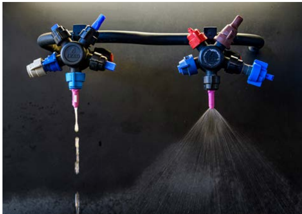
Abb. 23+24: Verstopfte Spritzdüsen (li.) müssen immer wieder gereinigt werden. Auch dabei ist PSA zu tragen (re.).
