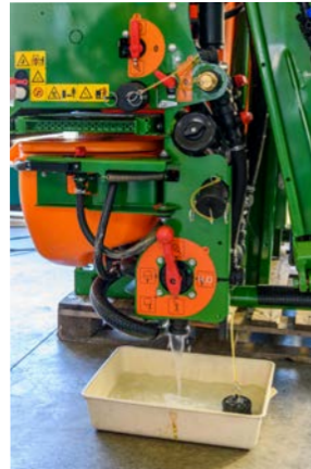
Abb. 21+22: PSA ist beispielsweise bei der Filterreinigung (li.) und dem Ablassen der Spritzbrühe (re.) sowie des Spülwassers nötig.
