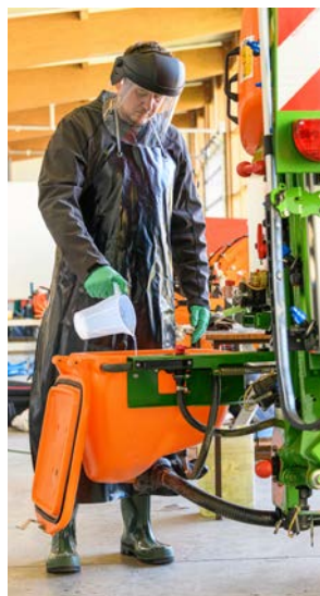
Abb. 5+6: Einfüllen des PSM-Konzentrats direkt in den Pflanzenschutzgerätetank (li.) und über eine Einspülschleuse (re.)
