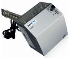
Die ELWA ist ein stufenloser Verbrauchsregler, der den überschüssigen Photovoltaikstrom für die Warmwassererwärmung sowie die Raumheizung heranzieht. Als einziges System bietet ELWA die Möglichkeit, den von der Photovoltaikanlage erzeugten Gleichstrom über einen Elektroheizstab direkt in Wärmeenergie umzuwandeln. Eine Netzanbindung ist in diesem Fall nicht zwingend notwendig. Mit dem AC-Thor lässt sich auch eine elektrische Fußbodenheizung stufenlos mit Photovoltaikstrom versorgen.
