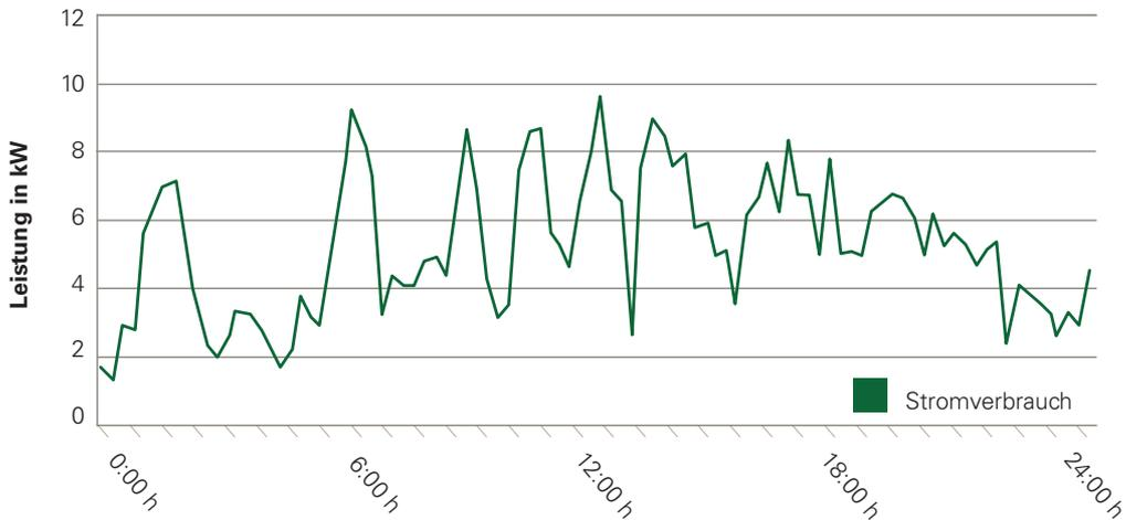
Das gezackte Lastprofil resultiert aus dem 24-stündigen Einsatz des Melkroboters. In der Zeit von 22:15 bis 0:15 Uhr wurde der Roboter von keiner Kuh besucht. Die Spitzenlast beträgt 9 kW, die Grundlast 1,9 kW. Der Melkroboter verursacht gegenüber dem Melkstand deutlich geringere Stromspitzen.
