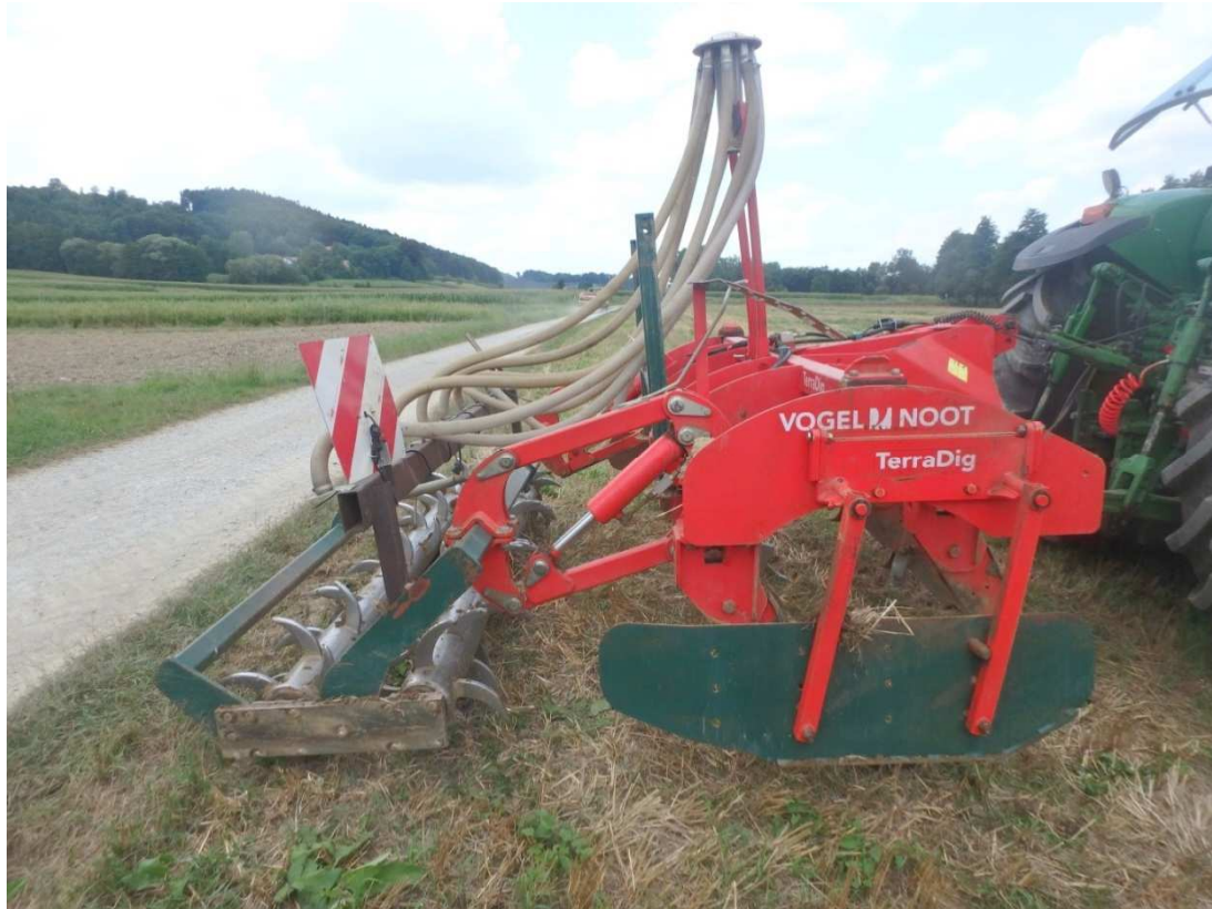
Tiefenlockerer mit engem Strichabstand und Doppel-Stachelwalze
