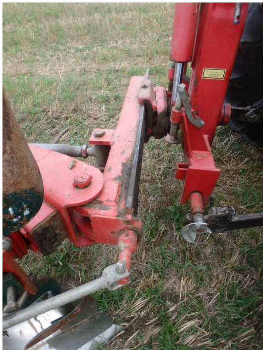
Umgedrehter Grenz-Pflug-Anbaubock zum On-Land-Pflügen
