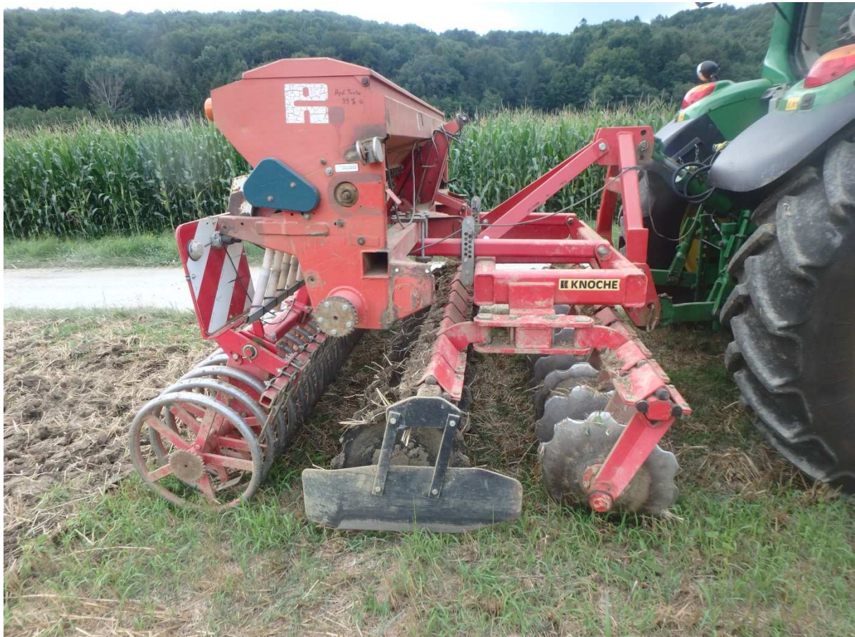
Kurzscheibenegge mit Rohrringwalze (und aufgebauter Sämaschine)
