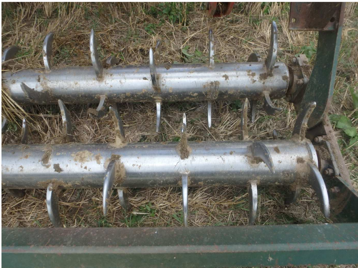
Doppel-Stachel-Walze zur Zerkleinerung, aber wenig Rückverdichtung
