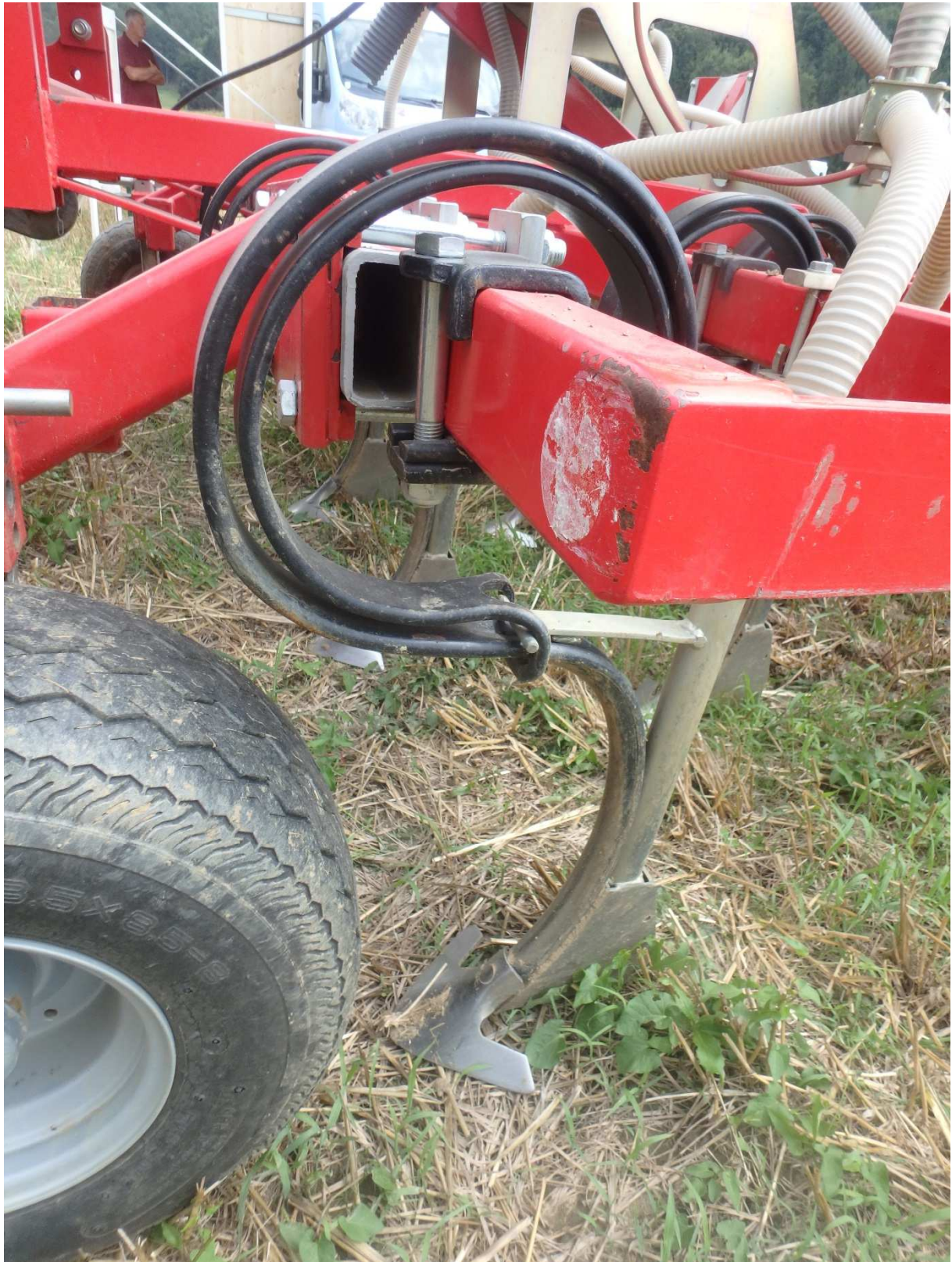
Doppelfeder-Zinken mit Gänsefußschar (und Saatstiefel für die Zinkensaat)
