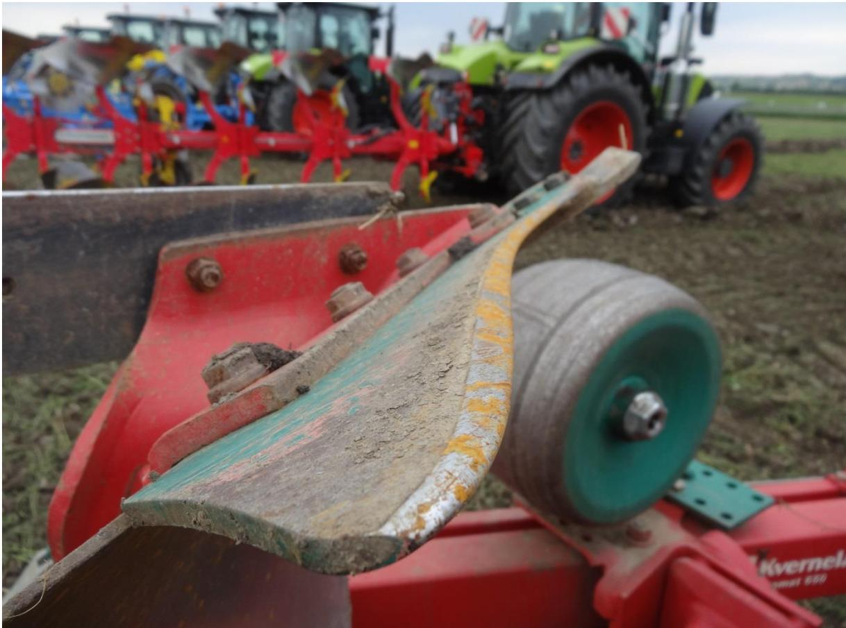
Abb.8: Halb abgenutzte Pflugschare, breitere Schnittkante, großer Untergriff der neuen Scharspitze
