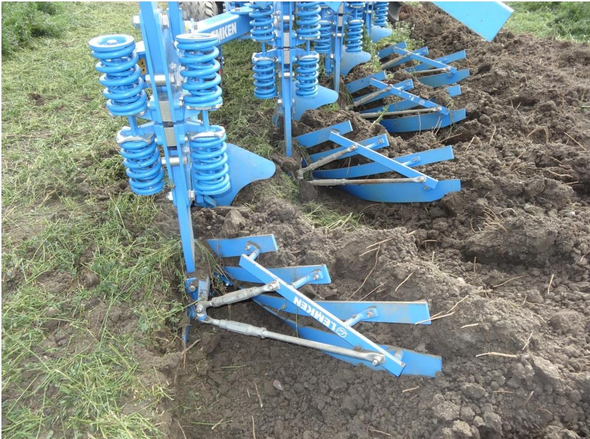
Abb.3: Ganzflächiger Umbruch, scharfkantig brechende Unterkrume an der Oberfläche, grobe Brocken im Erdbalken, keine Verschmierung der Pflugsohle
