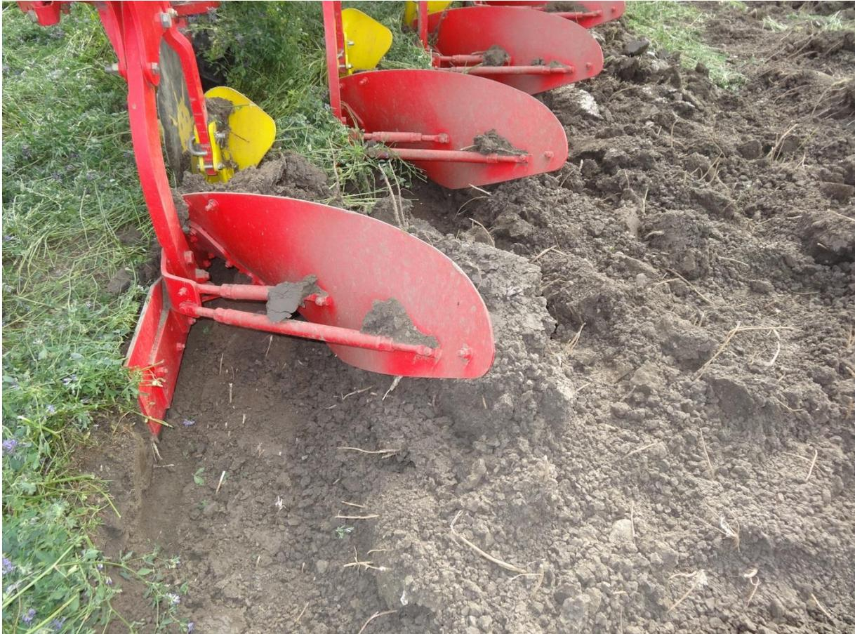
Abb.6: Ganzflächiger Umbruch, weniger scharfkantig brechende Unterkrume an der Oberfläche, weniger Brocken im gewendeten Erdbalken, z.T. Verschmierung der Pflugsohle
